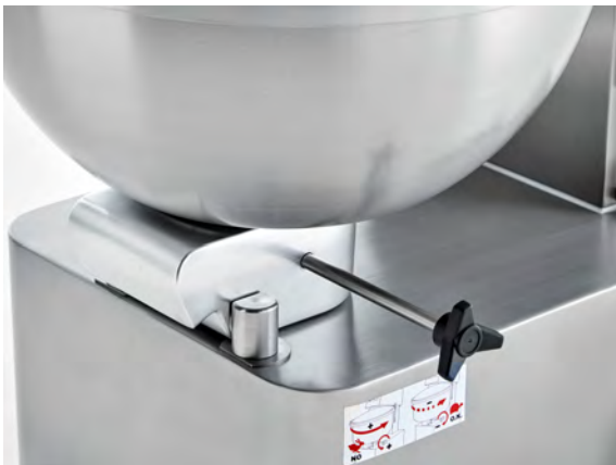
Vitesse de rotation de la cuve réglable par frein en modèles E
