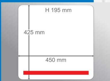
**Barre de soudure 420 mm | Hauteur de produit max 195 mm
